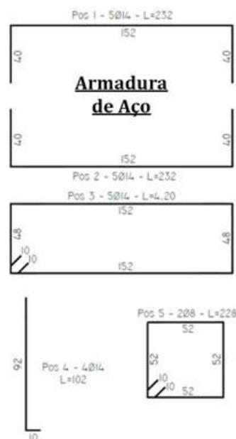
Figura 90 - Exemplo de projeto de armadura de aço para fundação tripolar
